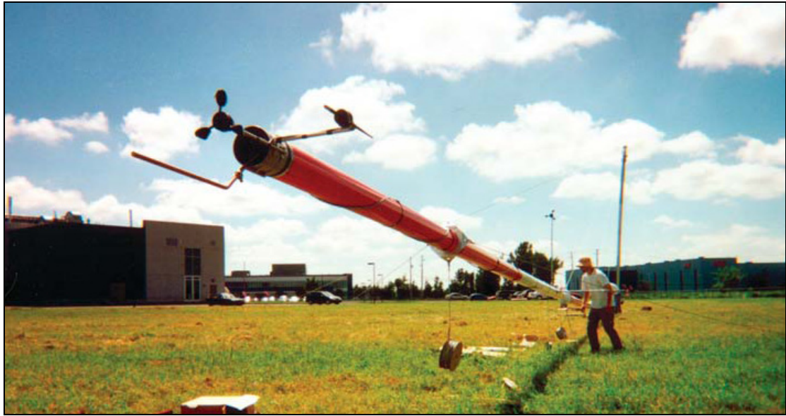
Εικόνα 7: Ιστός μετεωρολογικών μετρήσεων ύψους 40 m.
