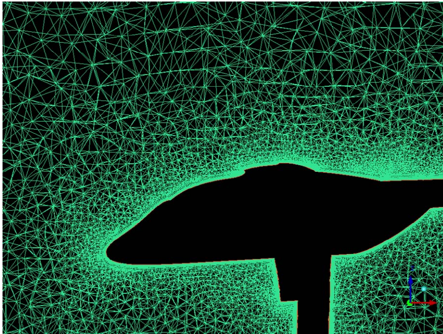
Σχήμα 11 Κατά μήκος τομή στο πλέγμα γύρω από ελικόπτερο για τον υπολογισμό συνεκτικής τυρβώδους ροής.
