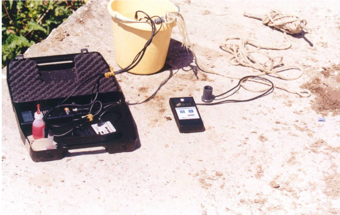
Εικόνα 2 : Φορητό Μηχάνημα (Consort) με ηλεκτρόδια για τον προσδιορισμό των ασταθών παραμέτρων
