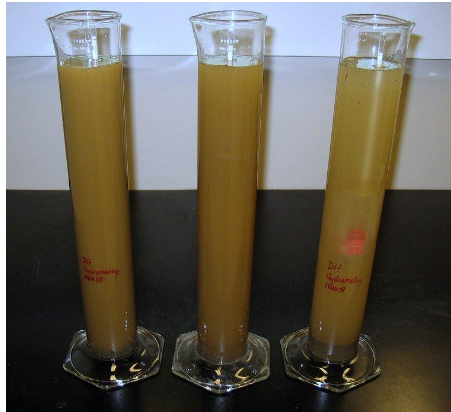
Εικόνα 4: Έμμεση μέτρηση μεγέθους κόκκων λεπτόκοκκων υλικών που στηρίζεται στην διαφορετική ταχύτητα καθίζησης των κόκκων μέσα στο νερό, με βάση το διαφορετικό τους μέγεθος.
