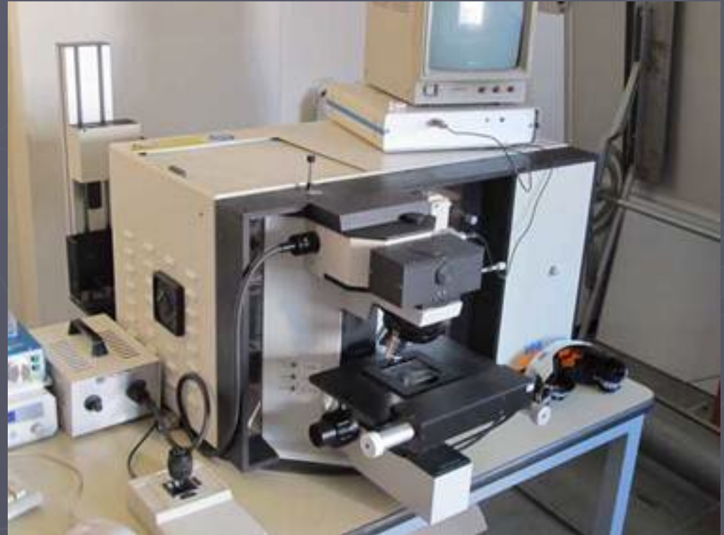
Συσκευή Raman για την μελέτη ρευστών εγκλεισμάτων στο Πανεπιστήμιο της Γενεύης
