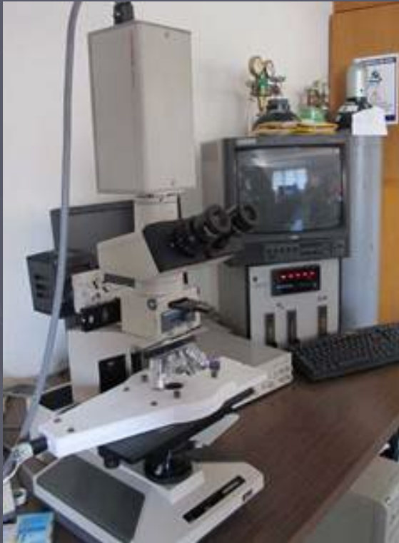
Θερμοτράπεζα μελέτης ρευστών εγκλεισμάτων στο Πανεπιστήμιο της Γενεύης
