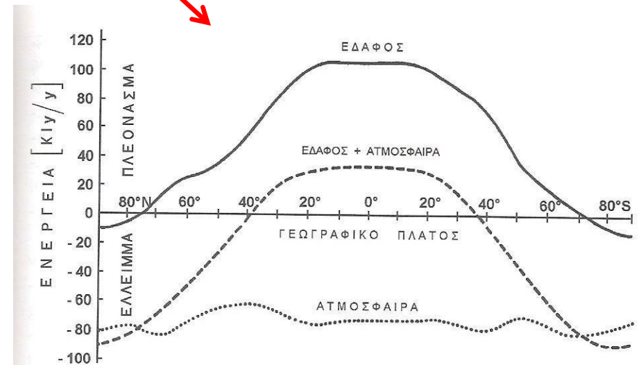
ΣΧΗΜΑ 2.4.1. Η μέση ετήσια κατά γεωγραφικό πλάτος κατανομή του ενεργειακού υπολοίπου των ακτινοβολιών της επιφάνειας της γης R_s , της ατμόσφαιρας R_a και του συστήματος γη - ατμόσφαιρα R_g (Physical Climatology. W. D. SELLERS).
