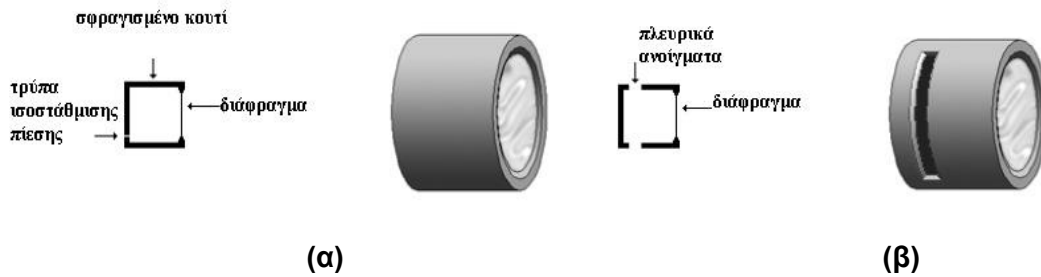
Σχήμα 4.10: τοποθέτηση διαφράγματος σε κλειστό κουτί (απόκριση μόνο από μία πλευρά του διαφράγματος), (β) κουτί με πλευρικά ανοίγματα (διαφορική απόκριση του διαφράγματος).
