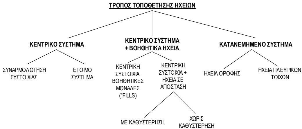
Σχήμα 7.10: Επιλογές για την τοποθέτηση των ηχείων
