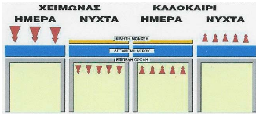
Σχήμα 3: Λειτουργία δεξαμενής οροφής κατά την ημέρα και κατά την νύχτα, το χειμώνα και το καλοκαίρι
