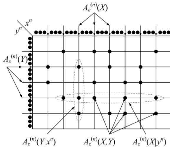
Στο σχήμα δίνεται ένα παράδειγμα από κοινού τυπικού συνόλου. Υπάρχουν περίπου  $2^{nH(X)}$  τυπικές ακολουθίες τ.μ.  $X$  και περίπου  $2^{nH(Y)}$  τυπικές ακολουθίες τ.μ.  $Y$ . Ωστόσο, οι από κοινού τυπικές ακολουθίες είναι περίπου  $2^{nH(X,Y)}$ , δηλαδή, υπάρχουν ζεύγη τυπικών  $X^n$  με τυπικά  $Y^n$  τα οποία δεν είναι από κοινού τυπικά.
