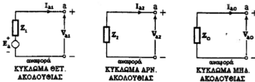
Σχήμα 2.2 Ακολουθιακά κυκλώματα σύγχρονης μηχανής
