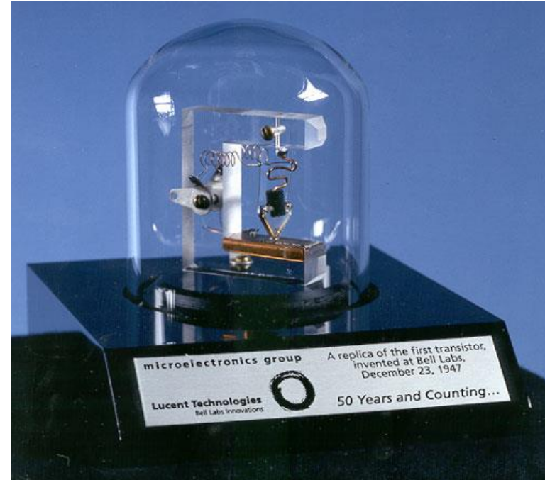
Εικόνα 12: Αντίγραφο της πρώτης υλοποίησης του τρανζίστορ
