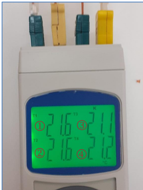
Σχήμα 5: Πειραματική διάταξη – οθόνη της καταγραφικής μονάδας, Datalogger με τέσσερα κανάλια
