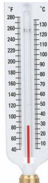
Σχήμα 3: Μέτρηση θερμοκρασίας με αναλογικό θερμόμετρο Δεξιά εικόνα: Στην κλίμακα °F: διακριτική ικανότητα 2°F, απόλυτο σφάλμα της μέτρησης \pm 1^{\circ}F , Στην κλίμακα °C: διακριτική ικανότητα 1°C, απόλυτο σφάλμα της μέτρησης \pm 0,5^{\circ}C
