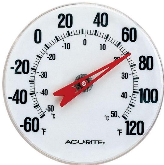
Σχήμα 3: Μέτρηση θερμοκρασίας με αναλογικό θερμόμετρο Δεξιά εικόνα: Στην κλίμακα °F: διακριτική ικανότητα 2°F, απόλυτο σφάλμα της μέτρησης \pm 1^{\circ}F , Στην κλίμακα °C: διακριτική ικανότητα 1°C, απόλυτο σφάλμα της μέτρησης \pm 0,5^{\circ}C
