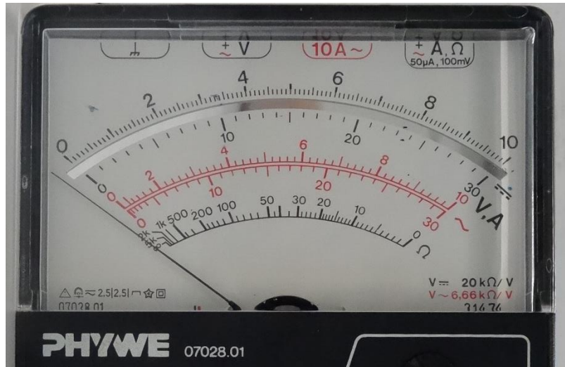
Σχήμα 2: Μέτρηση της τάσης, του ρεύματος και της αντίστασης με αναλογικό πολύμετρο Για παράδειγμα στην κλίμακα dc Volt, 0 – 10 V : διακριτική ικανότητα 0,1 V, απόλυτο σφάλμα της μέτρησης \pm 0,05 V
