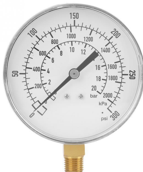
Σχήμα 4 Μέτρηση της πίεσης με αναλογικό μανόμετρο (πιεσόμετρο). Προσέξτε τις 3 διαφορετικές κλίμακες του οργάνου που αντιστοιχούν σε 3 διαφορετικές μονάδες
