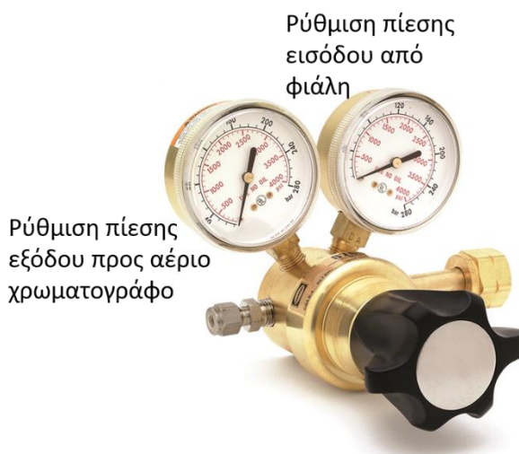
Σχήμα 3: Οι ρυθμιστές πίεσης (μανοεκτοντωτής) διαθέτουν δυο διαφορετικά στάδια ρύθμισης 1) υψηλή πίεση εισόδου 2) χαμηλή πίεση εξόδου (4.5 – 8 bar στην άσκηση).
