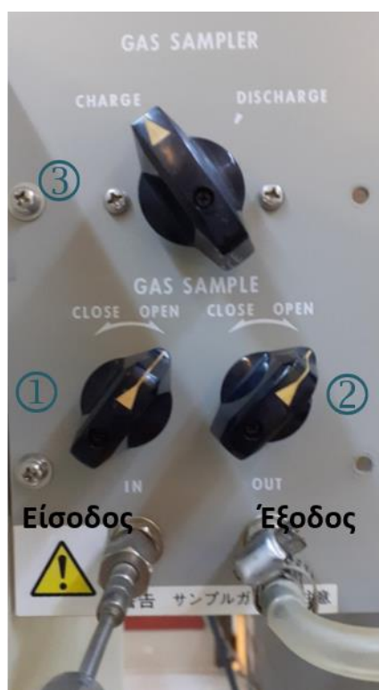
Σχήμα 5: Συγκεκριμένη λειτουργία της βαλβίδας έξι θυρών στο εργαστήριο
