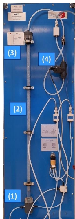
Σχήμα 4β. Πειραματική διάταξη του αυλωτός αντιδραστήρα PFR (QRPC).
