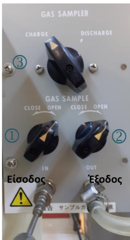
Σχήμα 6: Συγκεκριμένη λειτουργία της βαλβίδας έξι θυρών στο εργαστήριο
