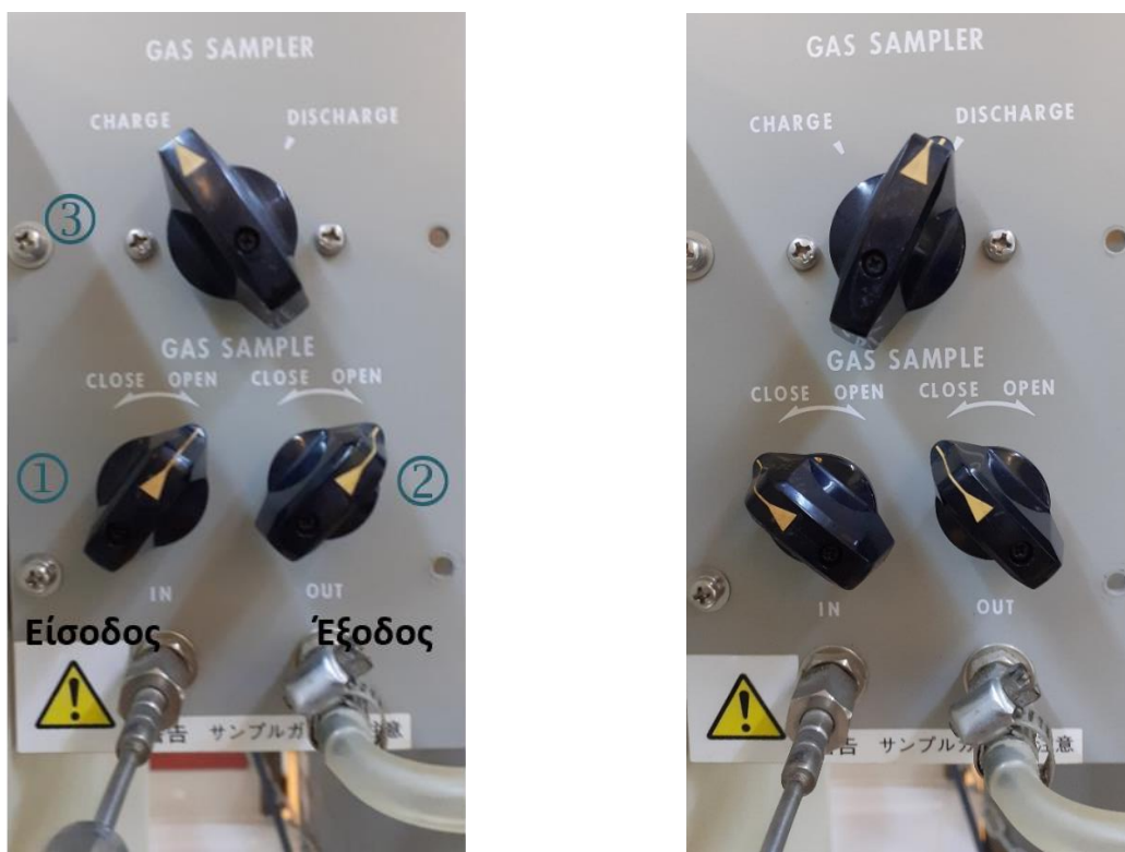
Σχήμα 6: Συγκεκριμένη λειτουργία της βαλβίδας έξι θυρών στο εργαστήριο
