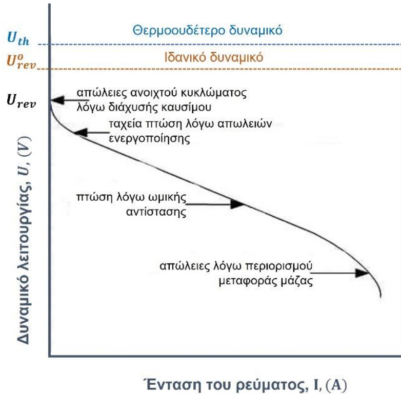
Σχήμα 4: Σχηματική καμπύλη δυναμικού – έντασης ρεύματος μιας κυψέλης καυσίμου.
