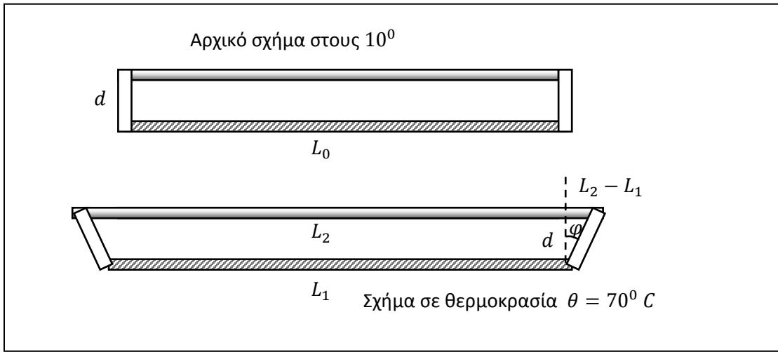
Λόγω θερμικής διαστολής  $L_2 = L_0(70 - 10)\alpha_2$  και  $L_1 = L_0(70 - 10)\alpha_1$  οπότε
