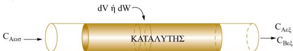
Σχήμα 14.3 Σχηματική αναπαράσταση ενός αυλωτού καταλυτικού αντιδραστήρα με σταθερή καταλυτική κλίνη.
