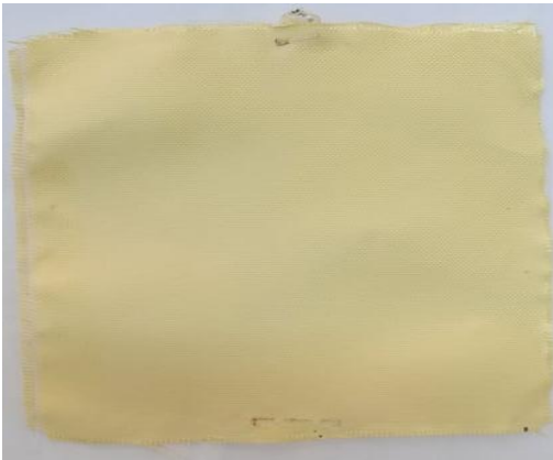
Δοκίμιο Kevlar® 20 x 20 cm με 10% διάλυμα του υδατοδιαλυτού πολυμερούς + 20% inorganic filler Material loading ( W_{\text{comp.}} / W_{\text{Kevlar}} ) : 10%
