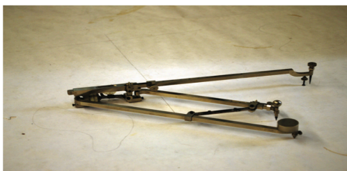
Σχήμα 2.83 Το εμβαδόμετρο είναι μια μηχανική συσκευή η οποία χρησιμοποιείται για τη μέτρηση των εμβαδών ακανόνιστων σχημάτων
