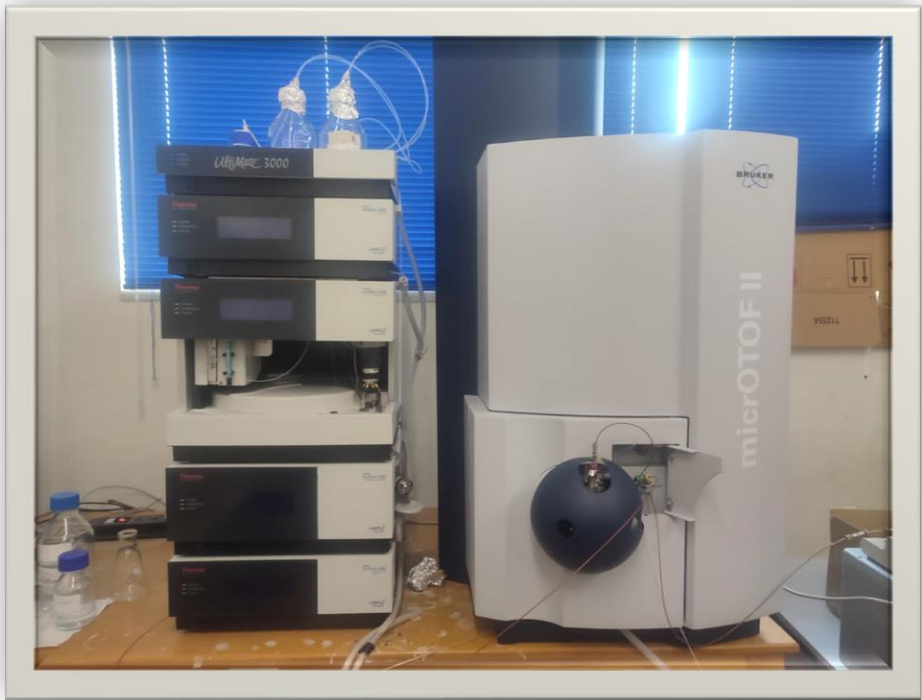
Σχήμα. Σύστημα Υγρής Χρωματογραφίας υπερυψηλής απόδοσης με αναλυτή μάζας χρόνου πτήσης.
