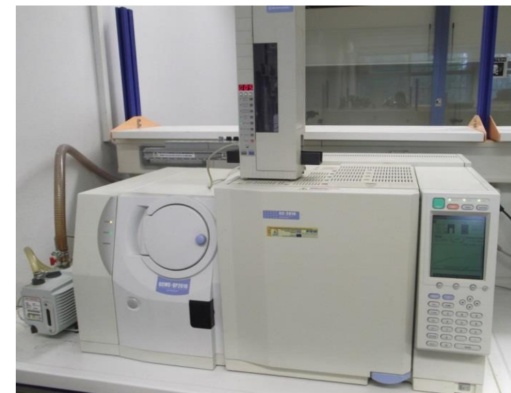
Σχήμα. Σύστημα αέριας χρωματογραφίας-φασματομετρία μάζας με πηγή ιοντισμού με πρόσκρουση ηλεκτρονίων (EI: Electron Impact/Electron Ionisation) μοντέλο QP-2010 (Shimadzu)
