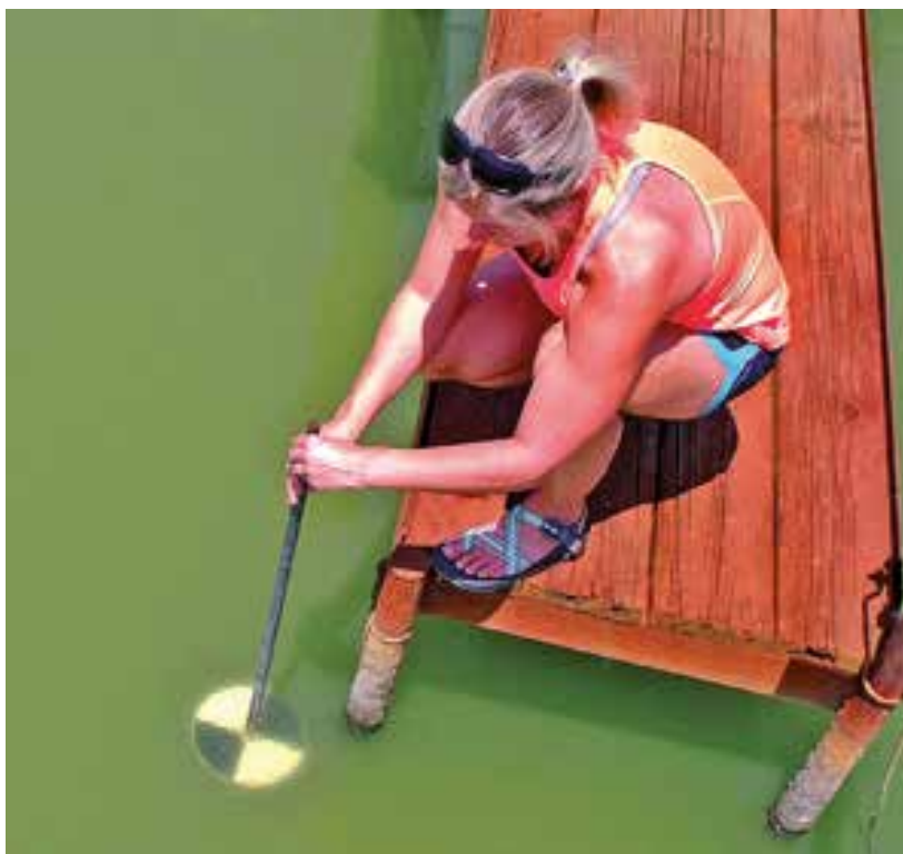
Εικόνα 4.2 Δίσκος του Secchi βυθίζεται στο νερό μιας λιμνοδεξαμενής για να προσδιοριστεί η θολερότητα. Χρησιμοποιώντας τις διαβαθμίσεις του σχοινιού (ή της λαβής), η θολερότητα μετράται με την επισήμανση του βάθους στο οποίο ο δίσκος δεν είναι πλέον ορατός. Πηγή: Αναπαράγεται με άδεια από τον Danny Oberle, 2017.
