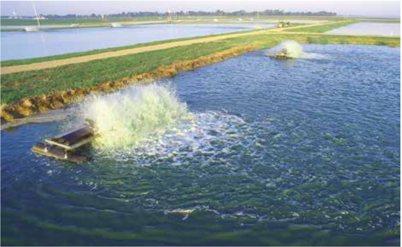
Εικόνα 4.9 Επιφανειακοί πτερυγιοφόροι αεριστήρες σε λιμνοδεξαμενή με γατόψαρα. Πηγή: Αναπαράγεται με άδεια από τον Danny Oberle, 2017.
