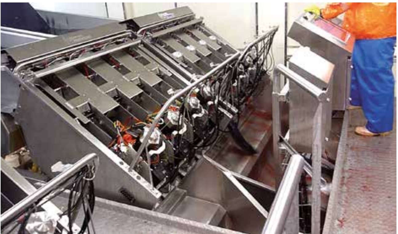
Σχήμα 13.4 Σολομοί κολυμπούν διαρκώς εντός δύο καναλιών των πλήρως αυτοματοποιημένων συστημάτων αναισθητοποίησης/αφαίμαξης Baader SI7C. Πηγή: Baader, SI. Αναπαράγεται με άδεια από τον S. Willoughby.
