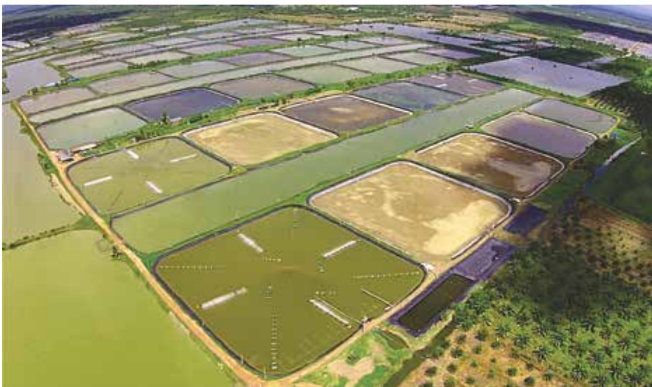
Εικόνα 5.8 Εκτροφή γαρίδας με ταμιευτήρα (τεχνητή λίμνη) για ανακύκλωση του νερού. Ο ταμιευτήρας αποτελείται από τα δύο ευρεία κανάλια και δύο μεγάλες λιμνοδεξαμενές στην επάνω δεξιά γωνία της εικόνας. Πηγή: Αναπαράγεται με άδεια από τον Aaron McNevin, 2017.
