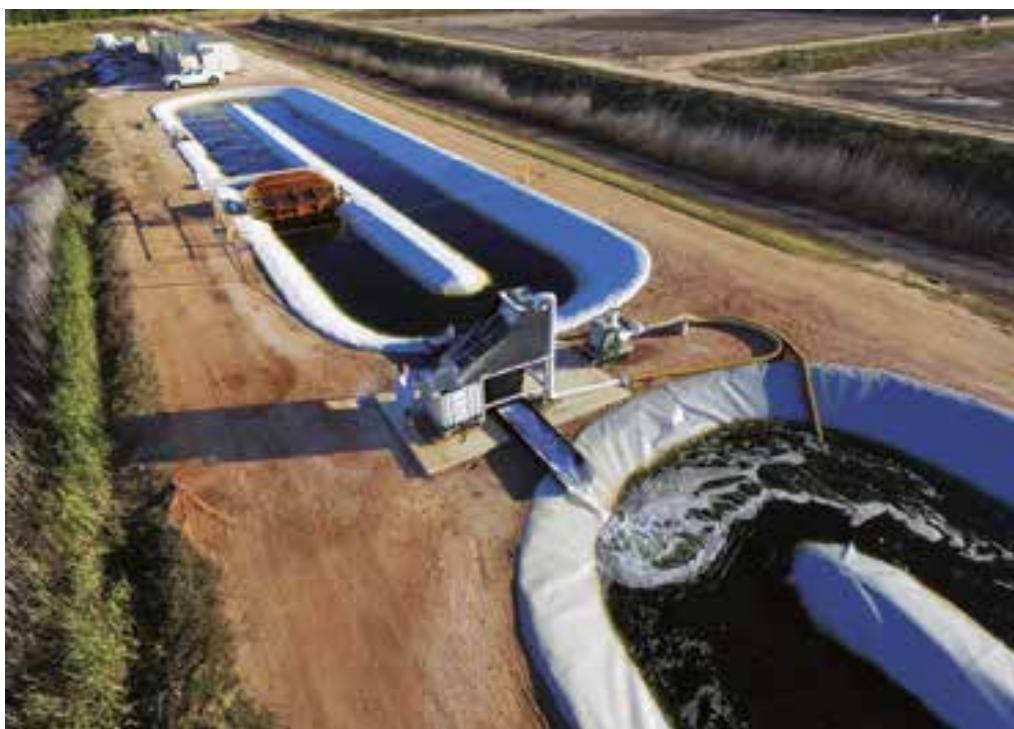
Εικόνα 2.5. Πειραματικά καναλόμορφα συγκοινωνούνται συστήματα καλλιέργειας 150.000 L που χρησιμοποιούνται για την επεξεργασία του νερού εκροής από μια καλλιέργεια γαρίδας στο Βόρειο Queensland της Αυστραλίας. Οι καναλόμορφες δεξαμενές περιέχουν πράσινα μακροφύκη ( Ulva sp.) που αφαιρούν διαλυμένα θρεπτικά συστατικά, έχοντας ως αποτέλεσμα ένα δευτερεύον εμπορικό προϊόν για την καλλιέργεια. Πηγή: Αναπαράγεται με άδεια από την MBO Energy Ltd.
