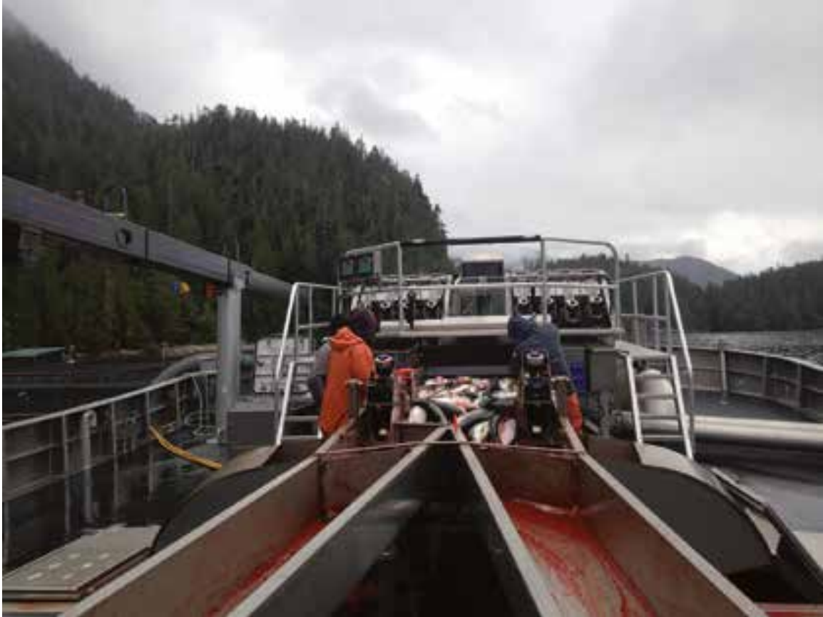
Σχήμα 13.5 Προηγμένα συστήματα αναισθητοποίησης/αφαίμαξης (2×4 κανάλια) τοποθετημένα επάνω σε βάρκα (με σφραγισμένο κανάλι απορροής για αποφυγή προβλημάτων λόγω ρύπανσης), για τη μεταφορά στην ξηρά μέσα σε πάγο ψαριών που έχουν αναισθητοποιηθεί και έχουν υποστεί αφαίμαξη για περαιτέρω επεξεργασία. Πηγή: Baader, SI. Αναπαράγεται με άδεια από τον S. Willoughby.
