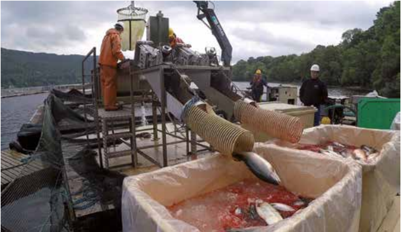
Σχήμα 13.3 Σολομοί ανυψώνονται με τη χρήση ενός μικρού δικτυού, μεταφέρονται σε δεξαμενές για σύντομο χρονικό διάστημα και στη συνέχεια τοποθετούνται χειροκίνητα σε συστήματα αναισθητοποίησης/αφαίμαξης τύπου Baader BA 101 τοποθετημένα παράλληλα. Πηγή: Baader, SI. Αναπαράγεται με άδεια από τον S. Willoughby.
