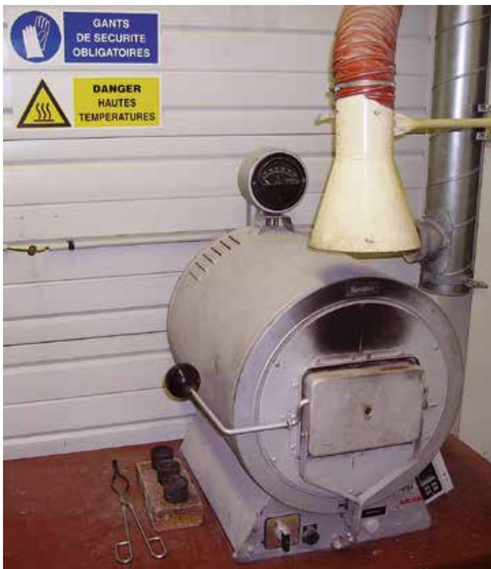
Εικόνα 6.11 Εργαστηριακός κλίβανος που χρησιμοποιείται για τον προσδιορισμό του αποτεφρωμένου ξηρού βάρους. Τα δείγματα ξηρού βάρους συνήθως τοποθετούνται σε κωνευτήρια μετάλλων ή πορσελάνης και ο χειρισμός τους γίνεται με λαβίδες. Πηγή: Cjr24 2009. Αναπαραγωγή με την άδεια Αναφοράς Δημιουργού - Παρόμοι-ας Διανομής Creative Commons, CC-BY-SA 3.0.
