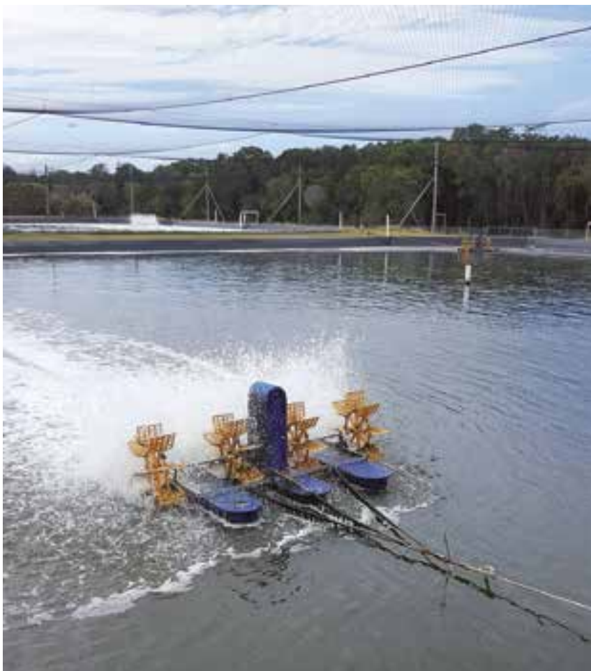
Εικόνα 3.12 Αεριστήρες τύπου επιφανειακών πτερυγιοφόρων αναμοχλευτών (paddlewheels) είναι ένας αποτελεσματικός τρόπος διατήρησης καλών επιπέδων διαλυμένου οξυγόνου στην υδατοκαλλιέργεια σε λιμνοδεξαμενές. Σημειώστε ότι πρόκειται για μια πλαστικοποιημένη λιμνοδεξαμενή που είναι κατασκευασμένη πάνω σε ένα πορώδες υπόστρωμα (άμμο) με εναέριο δίκτυο για προστασία από τους θηρευτές. Άλλα παραδείγματα αεριστών λιμνοδεξαμενής φαίνονται στην Εικόνα 4.9 και 4.10. Πηγή: Αναπαράγεται με άδεια από τον Paul Southgate.
