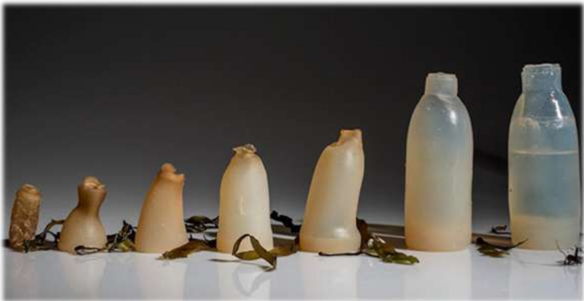
Σχήμα 3.63. Μια πολύ ενδιαφέρουσα εικόνα που δείχνει στάδια κατασκευής μπουκαλιού από οργανικά βιοπολυμερή εκχυλισμένα από φύκη για να παρασκευαστούν βιοδιασπώμενα δοχεία.
