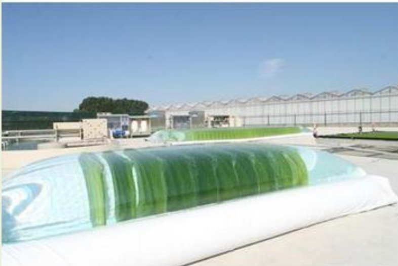
Πάνελ επίπεδων φωτοβιοαντιδραστήρων (PBR)
