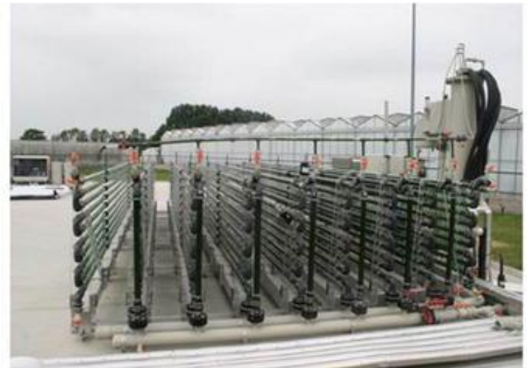
Κάθετοι σωληνοειδείς φωτοβιοαντιδραστήρες (PBR)
