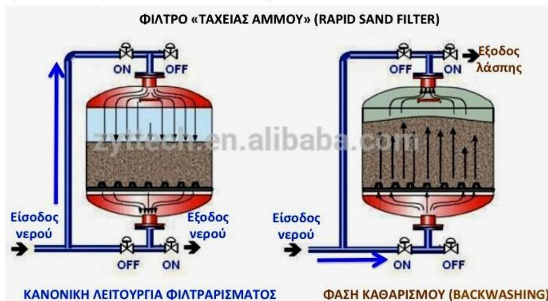
Σχήμα 45. Μηχανικό φίλτρο άμμου τύπου “ταχείας άμμου” (rapid sand filter) καθοδικής ροής νερού. Λειτουργεί με ροή νερού υπό πίεση δημιουργούμενη από αντλία. Πολύ αποτελεσματικό στην κατακράτηση σωματιδίων, καθαρίζεται εύκολα με αντιστροφή της ροής μέσω κατάλληλων ενεργοποιούμενων βαλβίδων (βανών). Από εμπορική διαφήμιση διαδικτύου «alibaba.com» τροποποιημένο από Γ. Χώτο.
