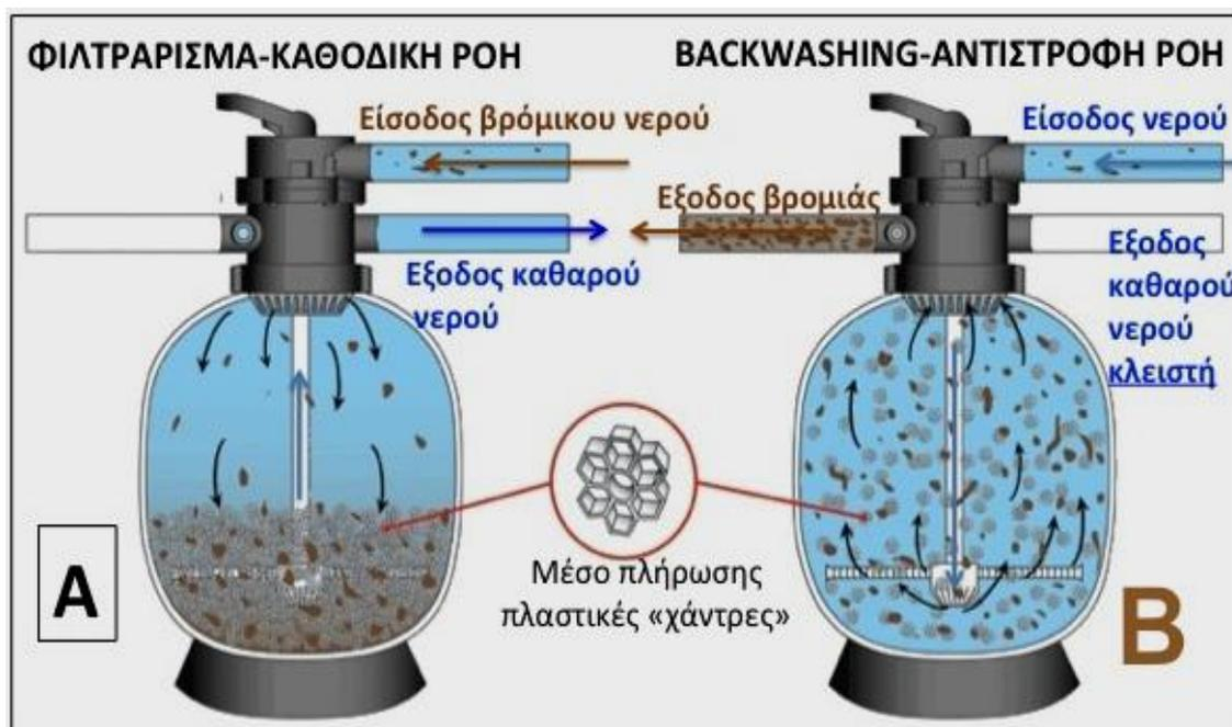
Σχήμα 41. Φίλτρο χαντρών καθοδικής ροής. A: Φιλτράρισμα, B: Backwashing.
