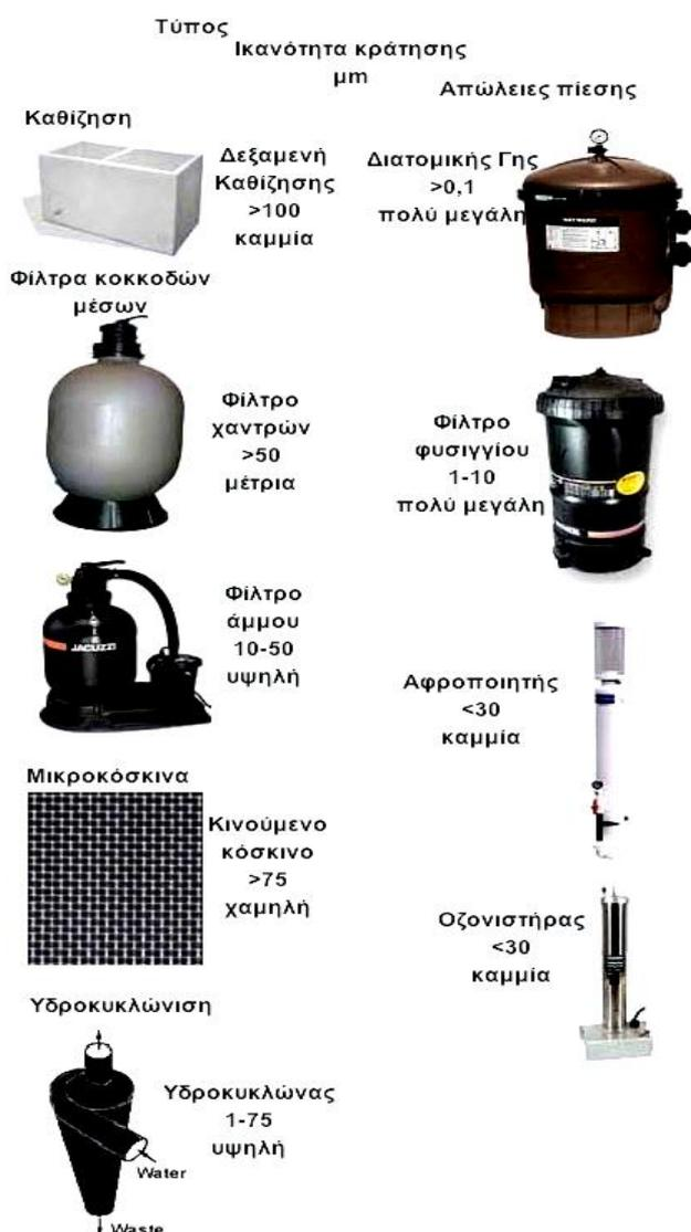
Σχήμα 37. Διαφόρων τύπων και υλικών πλήρωσης (μέσων) μηχανικά φίλτρα που χρησιμοποιούνται στην κατακράτηση των στερεών στα κλειστά συστήματα ιχθυοκαλλιέργειας. Δίδονται τα εύρη των μεγεθών των σωματιδίων που μπορούν να συγκρατήσουν καθώς και η επίδρασή τους στη ροή του κυκλοφορούντος νερού ως απώλεια πίεσης εξαιτίας της αντίστασης διέλευσης ανάμεσα στους πόρους των μέσων πλήρωσης, (κατά R. Strange-2004, τροποποιημένο από Γ. Χώτο).
