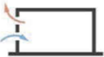
Μονόπλευρος αερισμός και ελκυσμός Φεγγίτες
