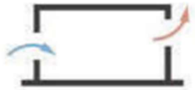
Διαμπερής αερισμός Αντικριστά ανοίγματα
