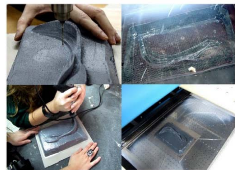
2. Δοκιμάσιμα κατασκευής συμπαγούς μοντέλου από DOW στο μηχανήμα CNC milling και δημιουργία vacuum form με την χρήση σφαίρας ως χρώς.
