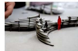
1. Δοκιμάσιμα κατασκευής μοντέλου eggcrate σε κλίμακα 1:50
