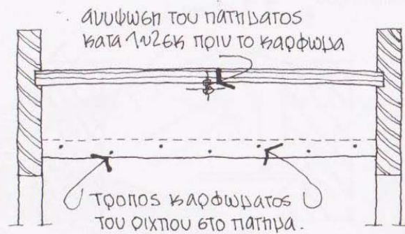
Σχ. 11.39. Ένωση πατήματος/ριχτιού με βαθμιδοφόρους.
