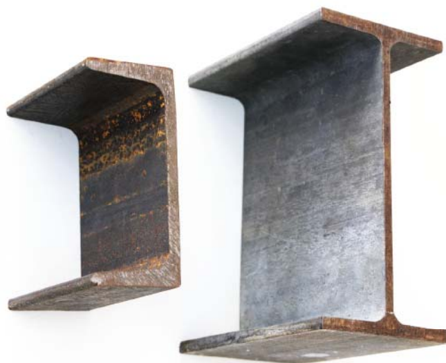
Εικόνα 5.19 Διατομές δομικού χάλυβα, αριστερά UNP και δεξιά IPE.
