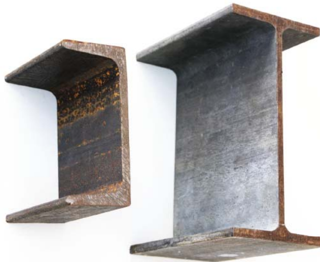
Εικόνα 5.19 Διατομές δομικού χάλυβα, αριστερά UPN και δεξιά IPE.
