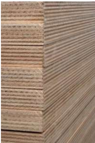
Τα Αντικολλητά Ξύλα (Plywood) ο διεθνής όρος, contre-plaque -κόντρα πλακέ- ο γαλλικός όρος.
