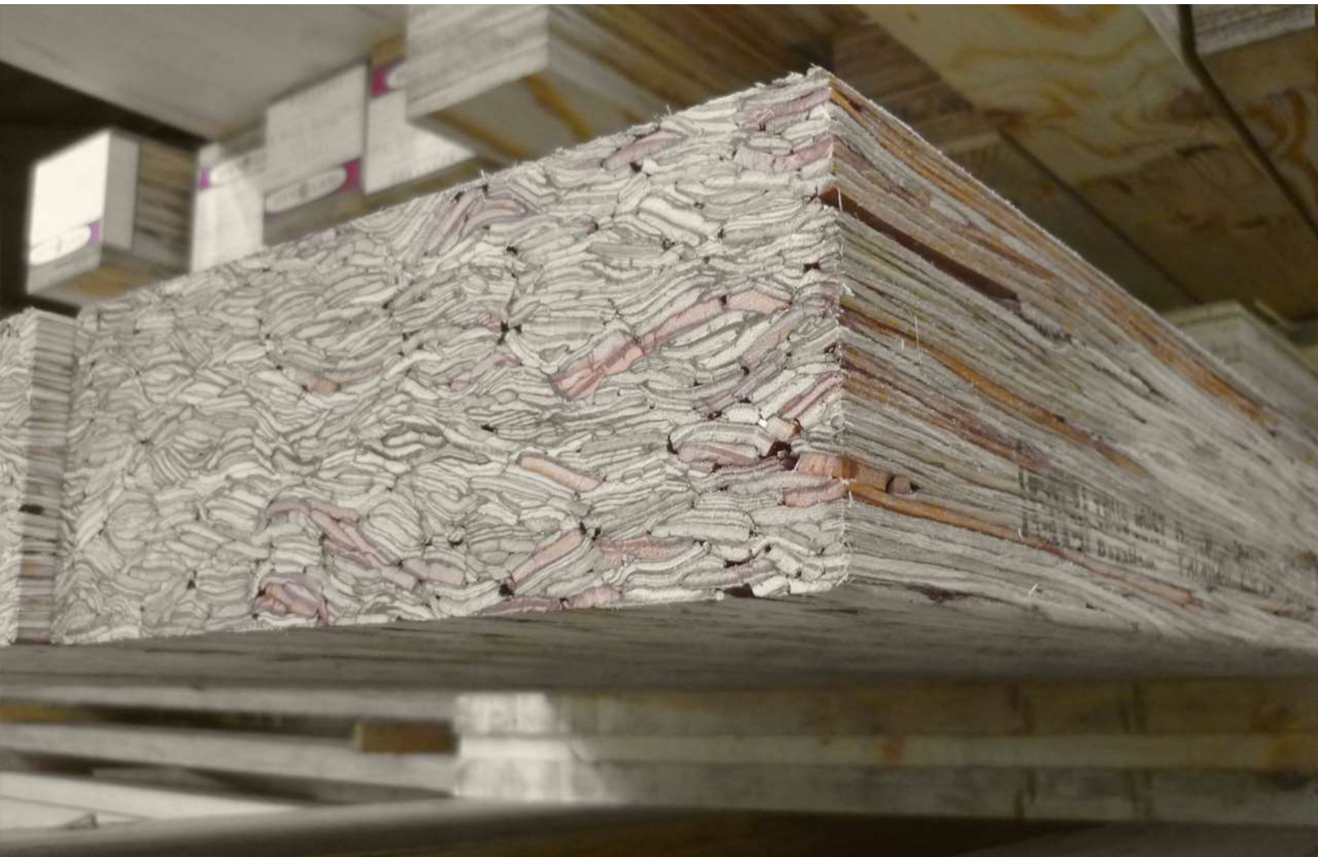
Oriented Strant Lumber (O.S.L.) – Ξυλοδοκοί από συγκολλημένες λωρίδες ξυλόφυλλων
